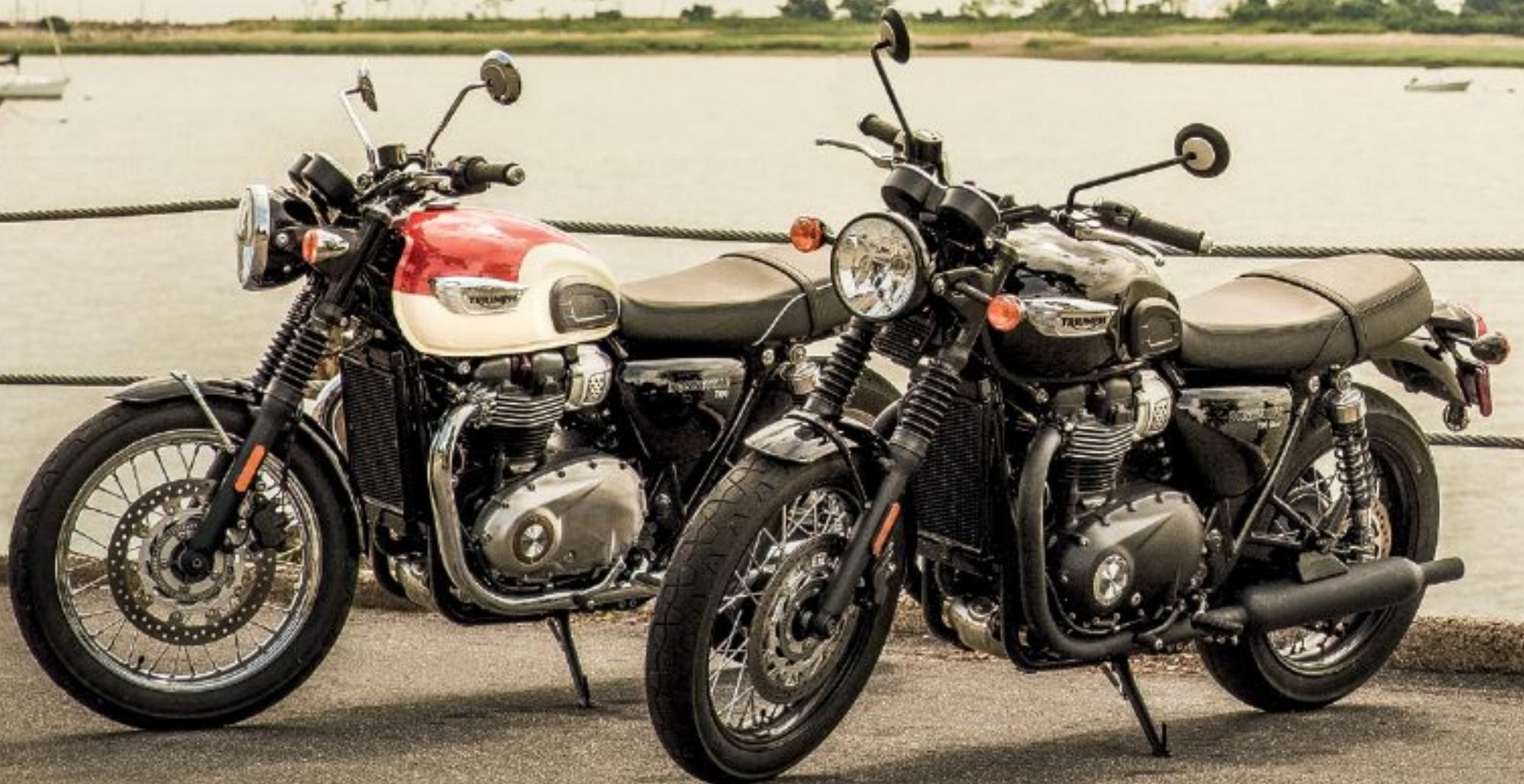
*Entrambe le moto sono alimentate da un bicilindrico parallelo "high-torque" a singolo albero a camme in testa e 8 valvole da 900 cc, con un caratteristico intervallo di accensione di 270° per una guida fluida e scattante. Con una maneggevolezza intuitiva e immediata, una sella più accessibile alta 790 mm per una posizione di guida rilassata e un bilanciamento eccezionale persino alle basse velocità, sono moto perfette da guidare ogni giorno e bellissime da ammirare.*
